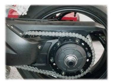
REMOVE THE ORIGINAL SCREWS ALONG THE FORK REMOVE THE ORIGINAL CHIAN COVER
